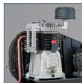
Tête de compression bi-étagée Cylindres fonte.
