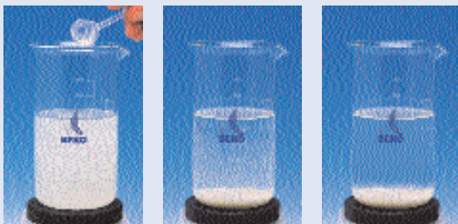
La flocculation est assurée par la bentonite
